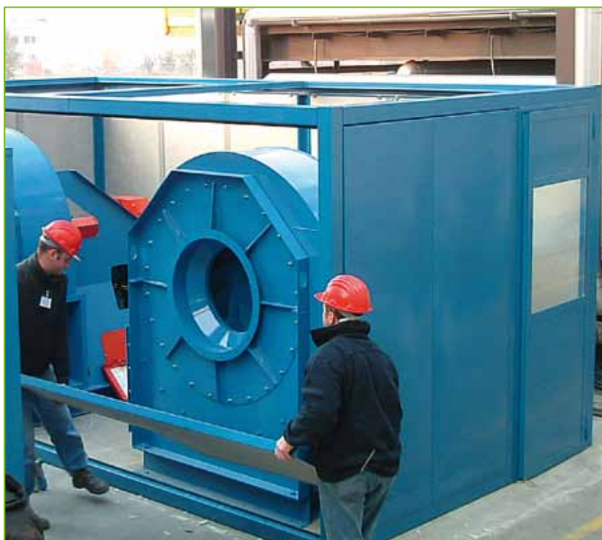
Cabina insonorizzante per ventilatori (con abbattimento del rumore da 90 dB a 65 dB)
