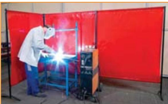
Schermo di protezione con struttura di colorazione nera leggera, piedini a T, tenda unica fissata alla doppia barra orizzontale. Altezza 2mt. sono disponibili con tenda unica 1460 - 2000 mm dallo spessore di 0,4mm. Disponibili in due colorazioni.
