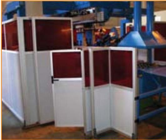
Pannello infrangibile ad altissima resistenza meccanica, ideale per la protezione di postazioni automatizzate. Le colorazioni Lansarc OR e R9 garantiscono la filtrazione totale dei raggi UV, IR e Luce blu; Lansarc OR in quanto anche trasparente assicura la visione attraverso la postazione evitando infortuni sul lavoro.
