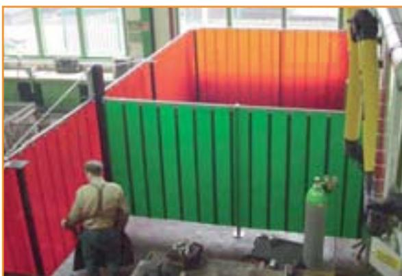
Soluzioni semplici, economiche e facili da assemblare. Il sistema di box di saldatura fissi sviluppato dalla Lansec, consente di acquistare una protezione perimetrale dell'ambiente di saldatura dalle dimensioni desiderate. I Kit completi e pronti per il montaggio, nelle versioni ad angolo, a tre lati e ad isola, comprendono montanti, fissaggi murali, binari, ganci e tende a strisce Lansarc OR.
